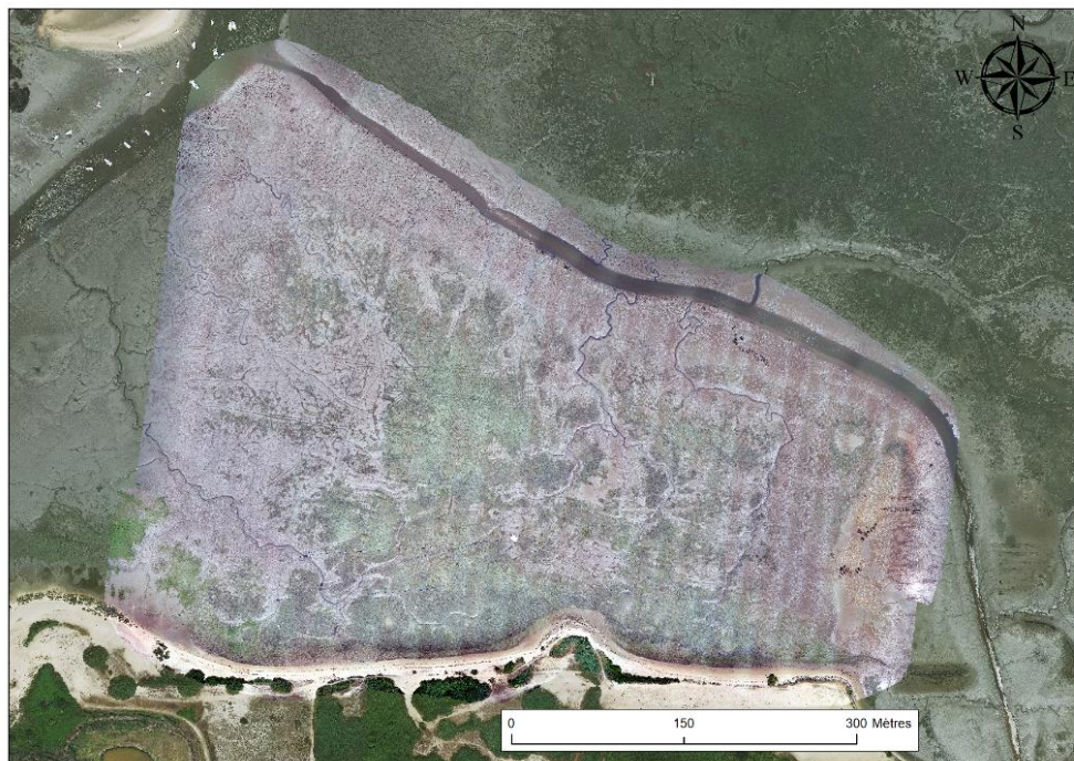
Figure A3 : Orthomosaïque générée à partir des images drone à La Teste de Buch.
