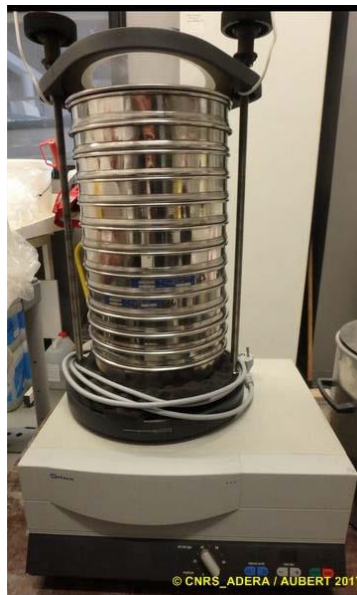
Figure 23 : Colonne de tamis normalisée AFNOR sur tamiseuse Retsch.
