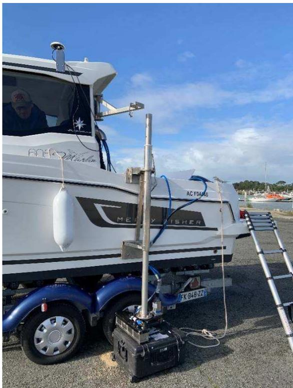
*Figure 6 : Base sondeur-centrale inertielle sur perche*
