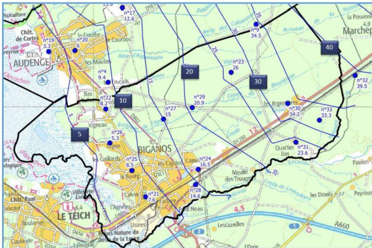
Figure 5-2 : Carte piézométrique (cotes en m NGF) de la nappe superficielle au droit de Biganos à la mi-janvier 2016
