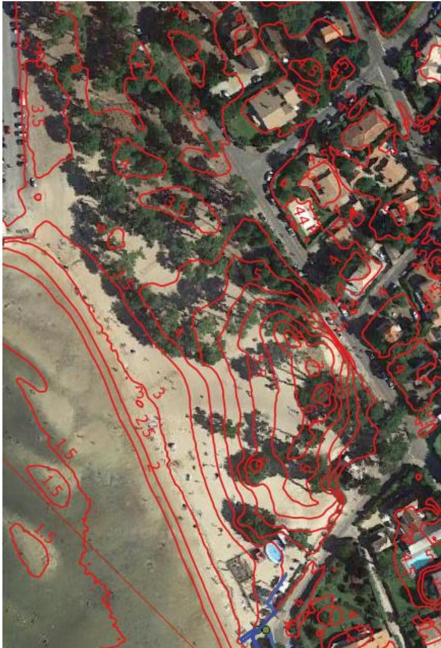
Figure 137 : courbes de niveaux (m NGF) à la zone de fermeture nord du système d'endiguement
