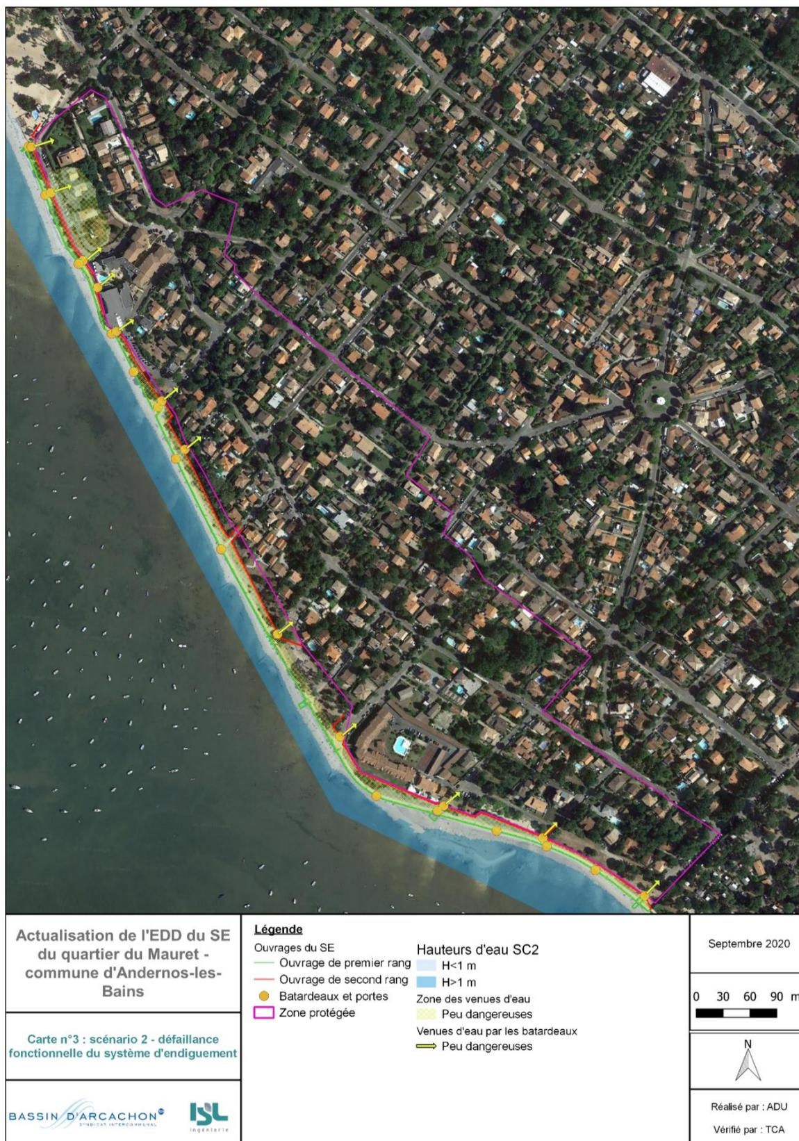
Figure 214 : carte n°3 - scénario 2 défaillance fonctionnelle du système d'endiguement
