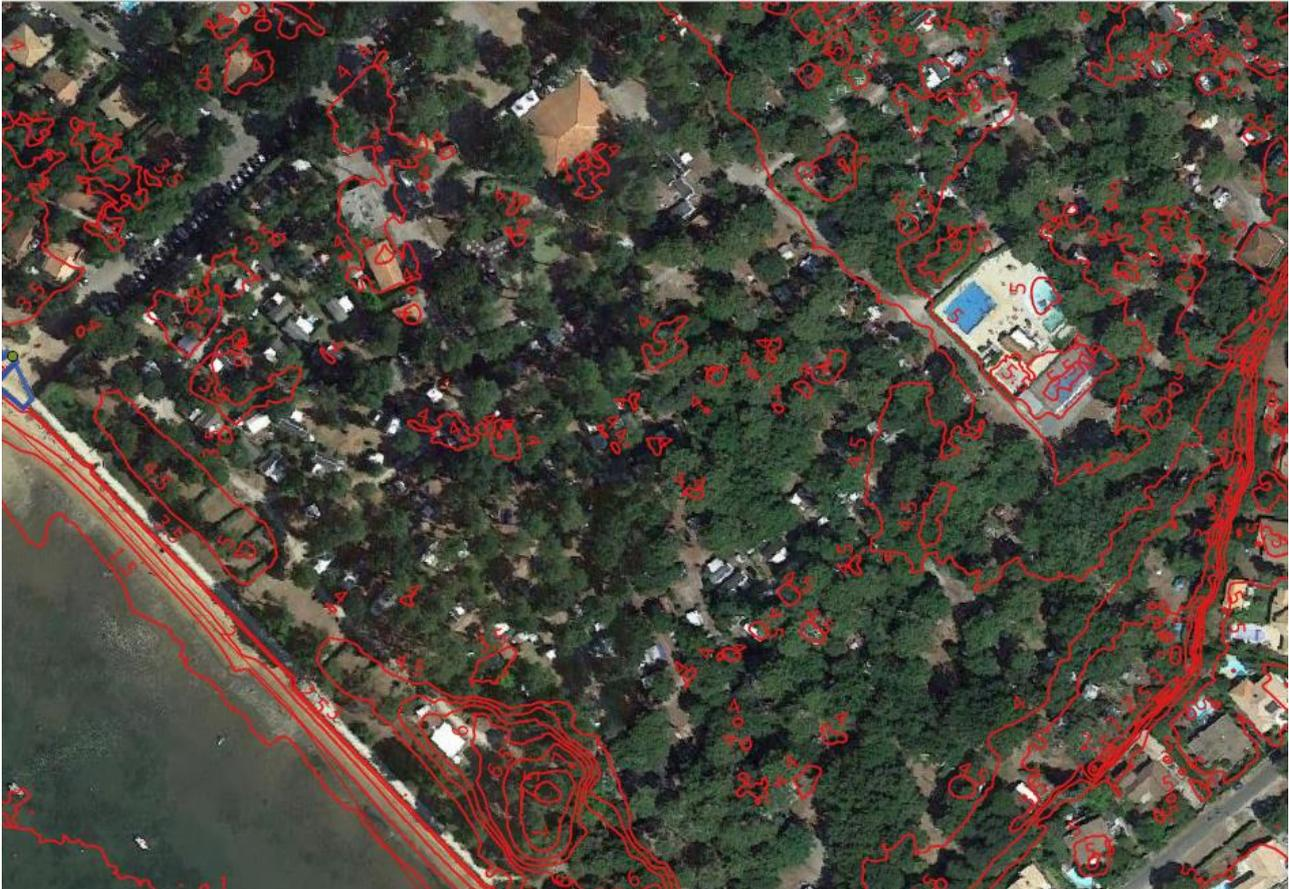
**Figure 138 : courbes de niveaux (m NGF) à la zone de fermeture sud du système d'endiguement
