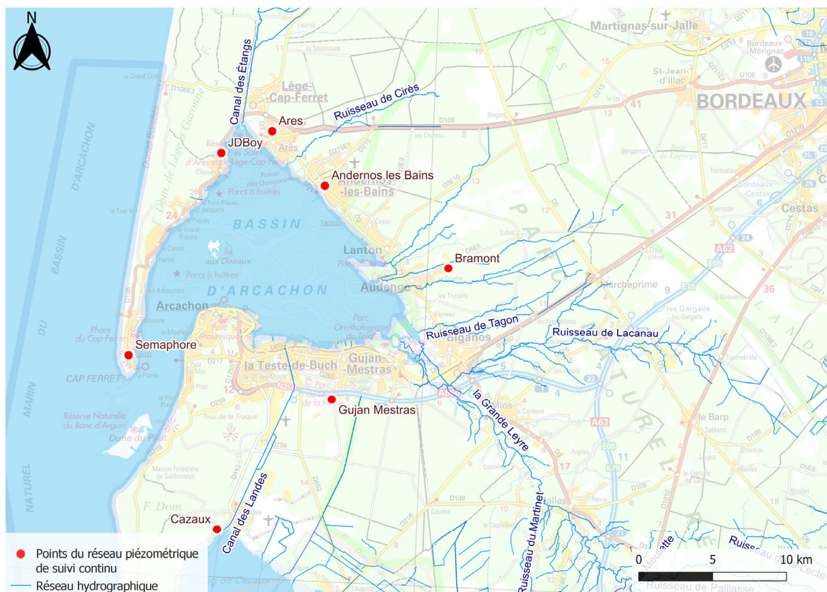
Illustration 2 - Localisation des piézomètres du réseau de suivi continu, mis en place par le SIBA
