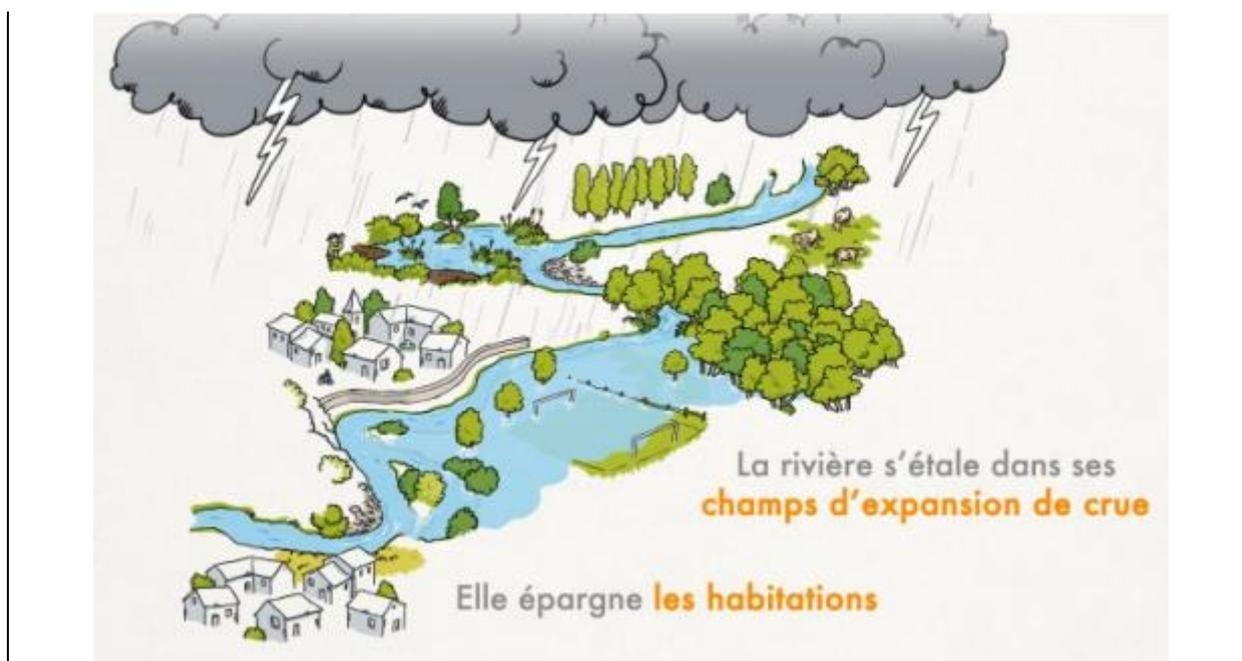
Figure 73 : Principe de fonctionnement d'une zone d'expansion de crue (AEAG)
