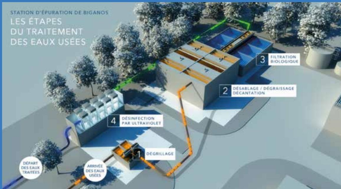
Le traitement primaire **1** et **2** permet de débarrasser les eaux consommées des gros déchets, des sables et graviers, des huiles et aussi des matières en suspension par des procédés physico-chimiques.
