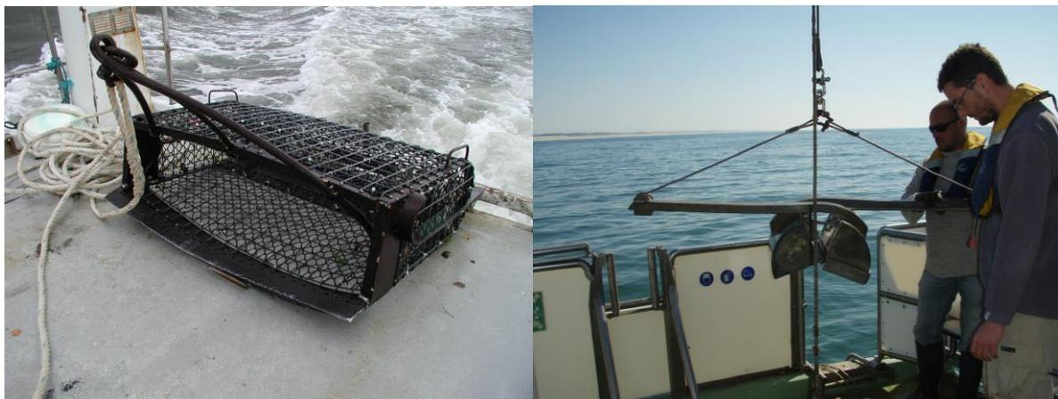
**Figure 2 : Prélèvements à la drague à coquilles (à gauche) et à la benne Van Veen (à droite)**
