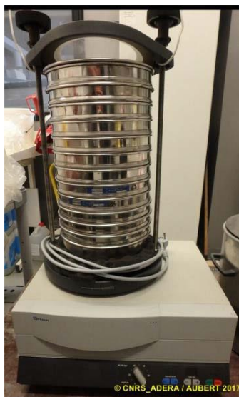
Figure 28: Colonne de tamis normalisée AFNOR sur tamiseuse Retsch.
