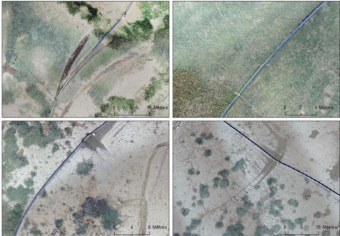
Figure 18 : Zoom sur les zones où la conduite de refoulement repose sur l'herbier. Images issues de l'orthomosaïque drone de 2021.
