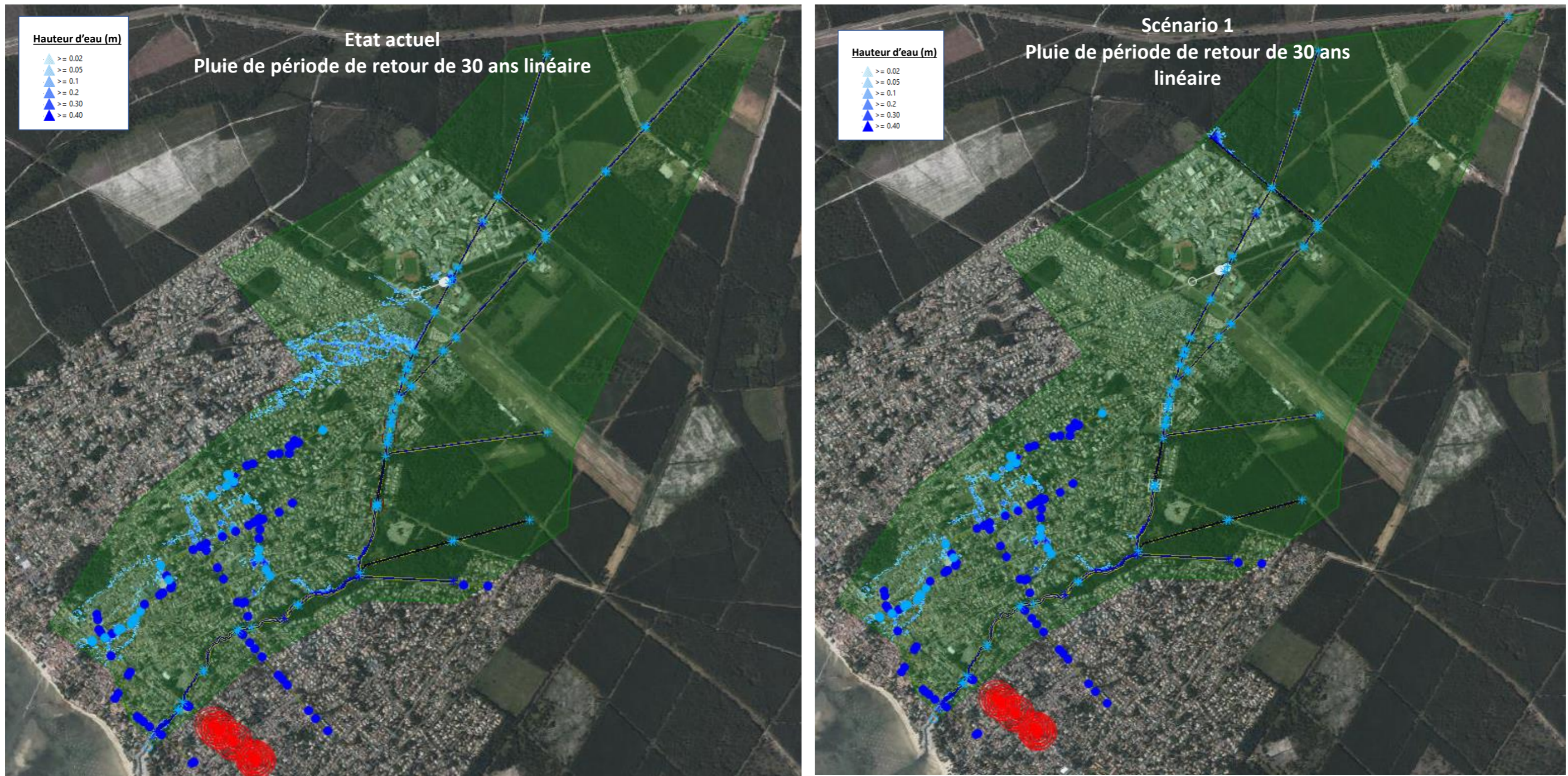
Figure 56 : Scénario 1 – Comparaison entre les zones de débordements en état actuel et celles simulées en état futur – Q30 – pluies linéaire
