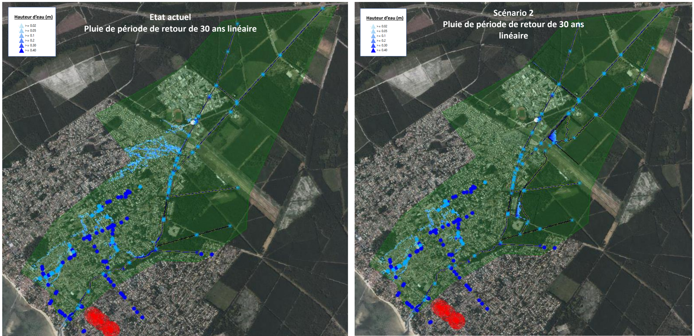
Figure 57 : Scénario 2 – Comparaison entre les zones de débordements en état actuel et celles simulées en état futur – Q30 – pluies linéaire
