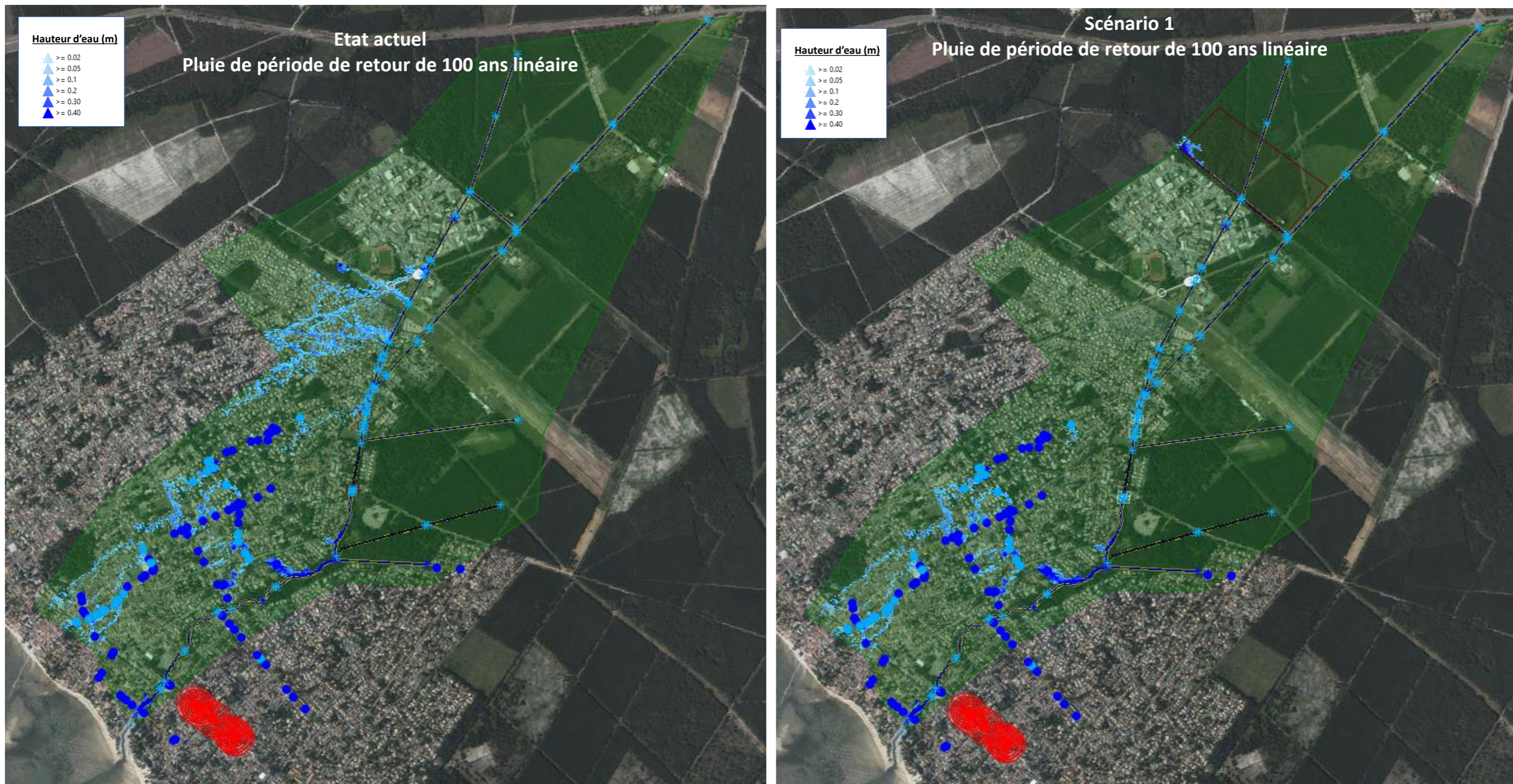
Figure 60 : Scénario 1 – Comparaison entre les zones de débordements en état actuel et celles simulées en état futur – Q100 – pluies linéaire
