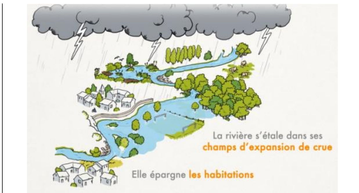
Figure 73 : Principe de fonctionnement d'une zone d'expansion de crue (AEAG)
