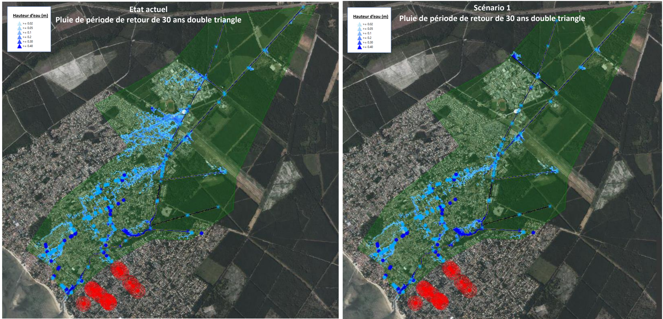
Figure 58 : Scénario 1 – Comparaison entre les zones de débordements en état actuel et celles simulées en état futur – Q30 – pluies double triangle
