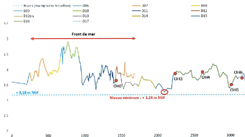
Niveaux de crête (m NGF) et distance cumulée (en m) des tronçons du casier Ouest (source : CASAGEC – VTA 2023)
