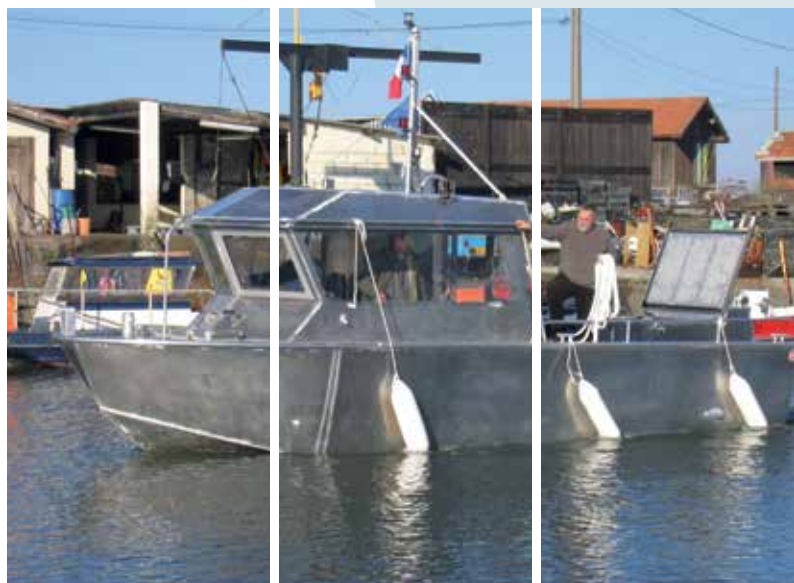
SIBA I - bateau spécialement conçu pour les besoins du service des études du SIBA, équipé pour les levés bathymétriques sur le plan d'eau
